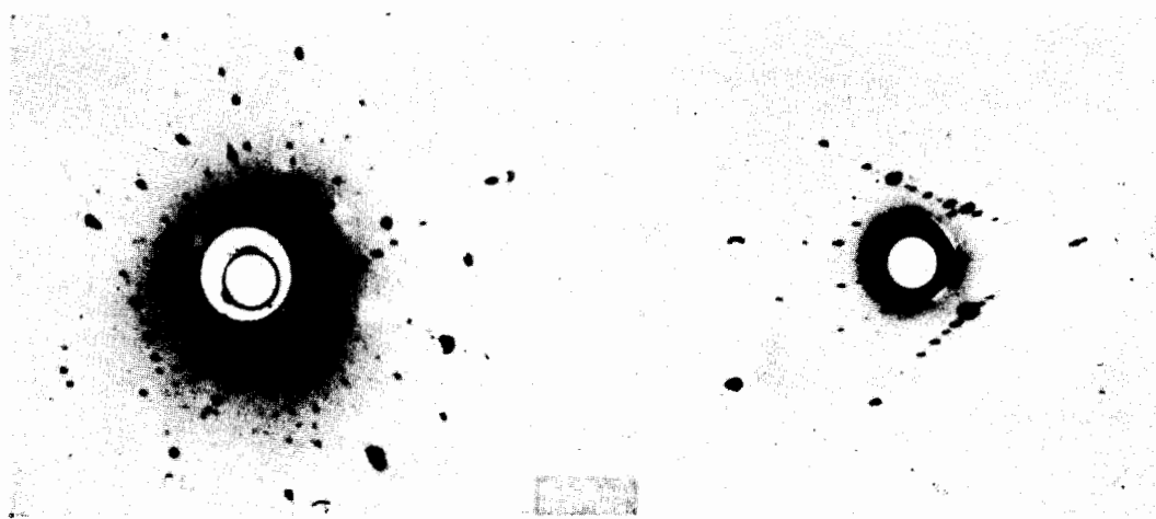
Рис. 6. Лауэграммы зерен 2 и 3 образца а-5
