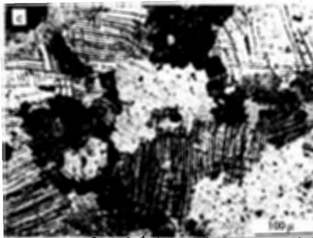
Figure 3. Évolution de la structure entre le bord et le centre d'un barreau de la figure 2 a et b: parties les plus froides; c et d: parties les plus chaudes
