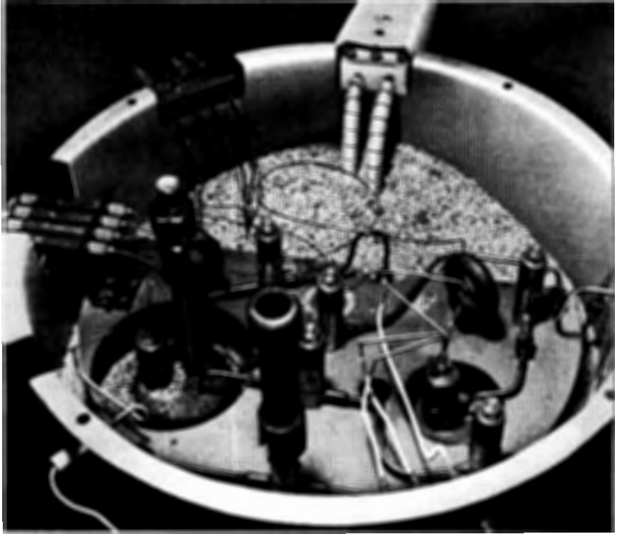
FIG. 4. Dispositif pour l'étude de l'échange H_2 - H_2O en phase liquide. Vue partielle. L'enceinte cylindrique calorifugée, de 40 cm de diamètre, contient l'ensemble des éléments sous pression (vaporisateur-surchauffeur; saturateur; réacteur d'échange).
