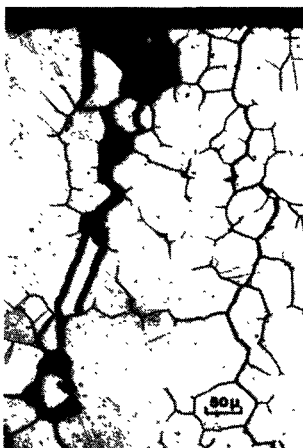
FIG. 1. Alliage Cr 17%, Ni 77% fissuré après six mois d'essai dans l'eau à 350° C ( O_2 \leq 0,003 mg/l).
