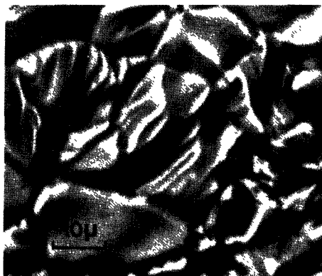
FIG. 12. Aspect superficiel de l'acier Z2 CN 18-10 après exposition de 6000 heures dans le sodium à 650° C.
