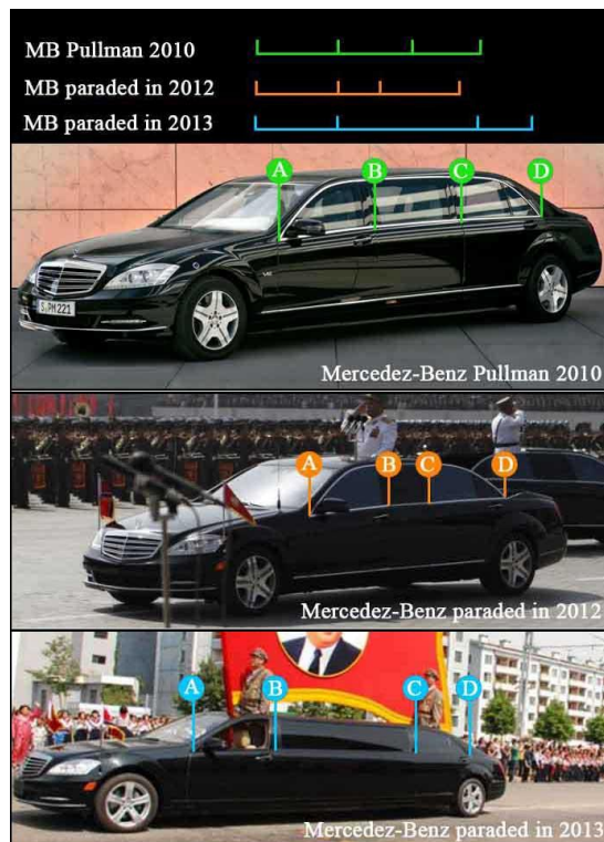
Gráfico XIX Análisis por el Grupo de las características del chasis de las limusinas observadas en 2012 y 2013-2014 y versión Pullman del Mercedes-Benz de la clase S
