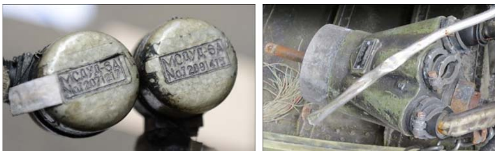
Figure IX Éléments de Scud réutilisés (manocontacts et connecteurs de séparation)
