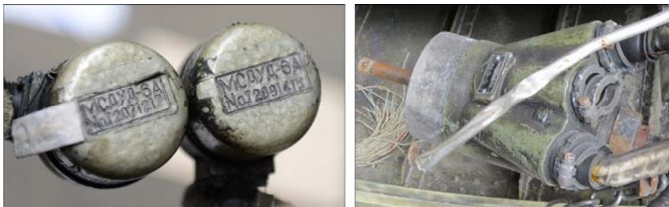
Figura IX Piezas aprovechadas de misiles Scud (presostatos y conector de separación)
