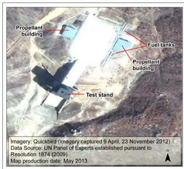
Рисунок VI Спутниковые снимки испытательного стенда на западном побережье, свидетельствующие об испытании двигателей
