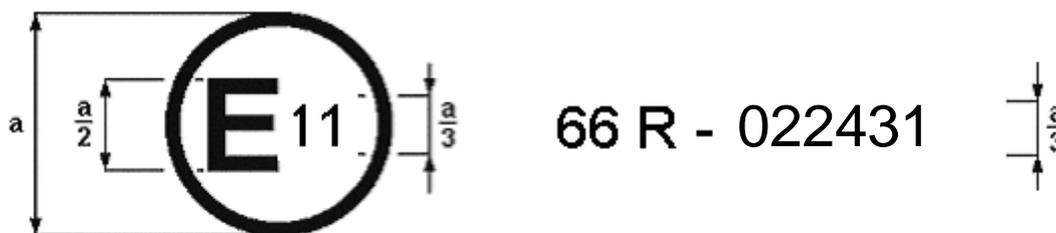
La marque d'homologation ci-dessus, apposée sur un véhicule, indique que le type de ce véhicule a été homologué au Royaume-Uni (E11) en ce qui concerne la résistance mécanique de sa superstructure, en application du Règlement No 66, sous le numéro 022431. Les deux premiers chiffres du numéro d'homologation indiquent que l'homologation a été délivrée conformément aux prescriptions du Règlement No 66, série 02 d'amendements.»
