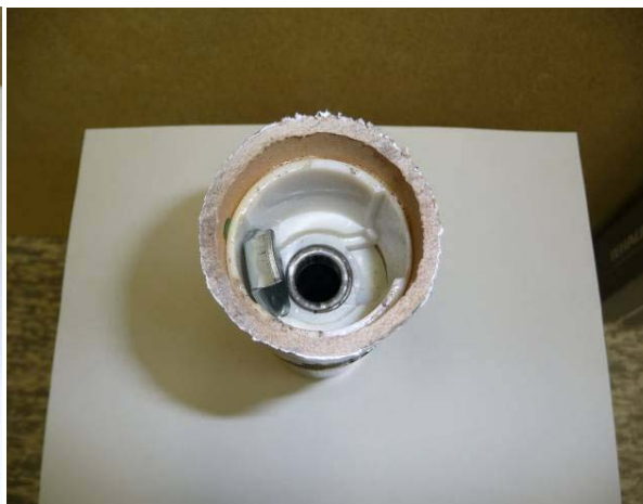
Figure 5 Mécanisme de verrouillage que l'on ouvre par rotation d'une bague en plastique
