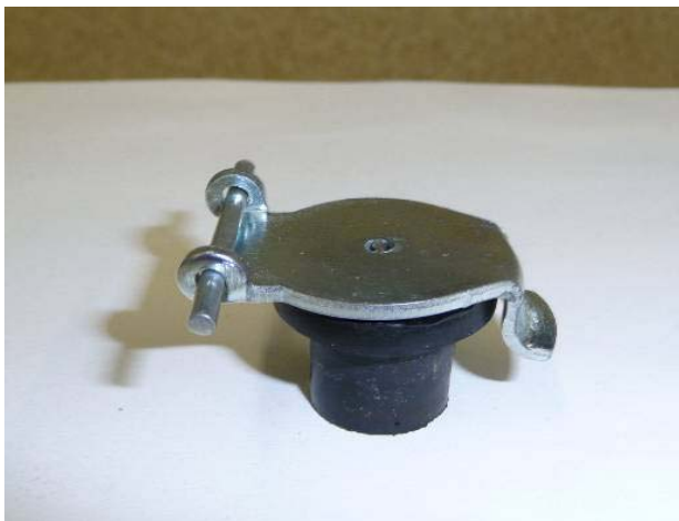
Figure 4 Obturateur en caoutchouc et clapet métallique destinés à sceller la cartouche
