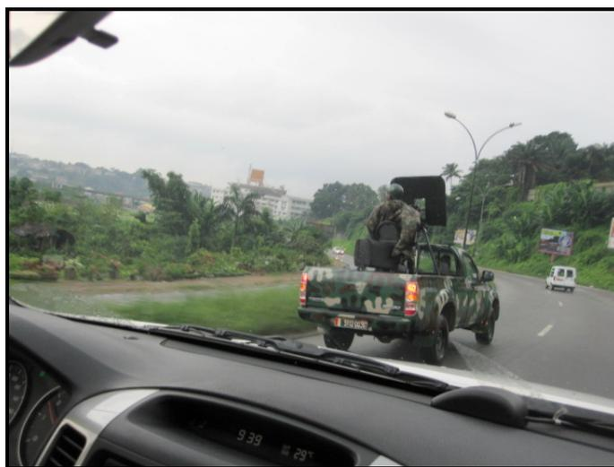
*Note* : La camionnette est un véhicule civil BT-50 de marque Mazda. L'arme est une mitrailleuse lourde 12,7 x 108 mm.
