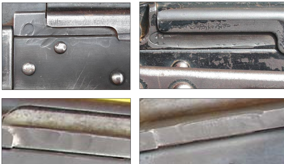
Figure IV Numéros de série (en haut) et de porte-culasse (en bas) effacés par meulage
