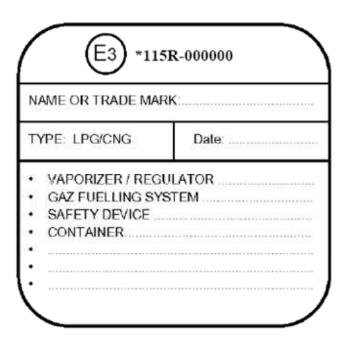
La plaque ci-dessus, qui contient la marque d'homologation ainsi que certains renseignements techniques sur le système d'adaptation, doit être apposée de façon permanente sur la carrosserie du véhicule.
