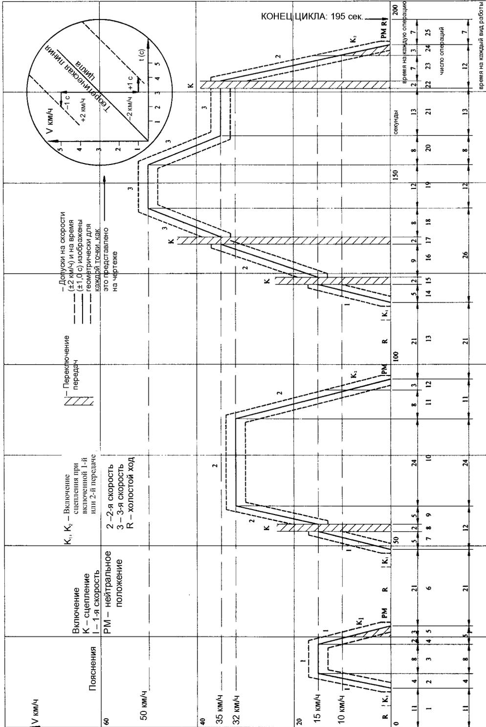
Рис. 3: Внегородской цикл (вторая часть) для испытания типа I
