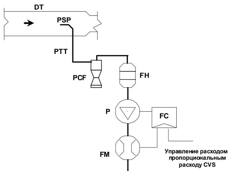
В случае разбавления полного потока проба разбавленных отработавших газов отбирается из канала для разбавления DT и пропускается через пробоотборник твердых частиц PSP и патрубок отвода твердых частиц PTT с помощью насоса для перекачки проб P. Проба проходит через
