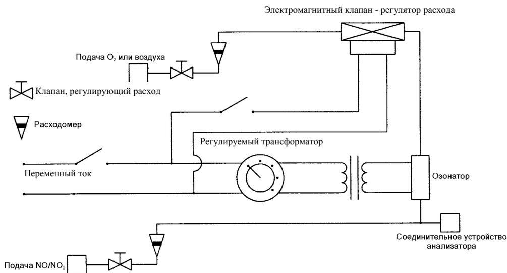
2.4.6 С отключением озонатора прекращается также поток кислорода или синтетического воздуха. При этом значение NO<sub>2</sub>, показываемое анализатором, должно не более чем на 5% превышать значение, указанное в пункте 2.4.1 выше.
