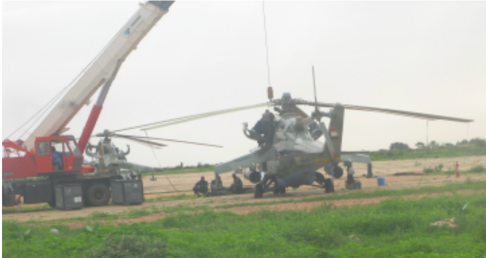
Fotografía 12 Sustitución del motor de un Mi-24 realizada en el aeropuerto de El Geneina el 21 de agosto de 2008
