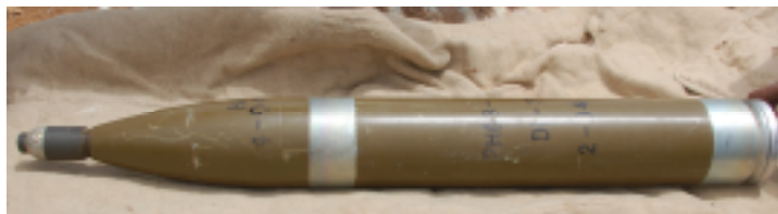
Fotografía 32 Cohete de 107 mm con espoleta de proximidad MJ-1
