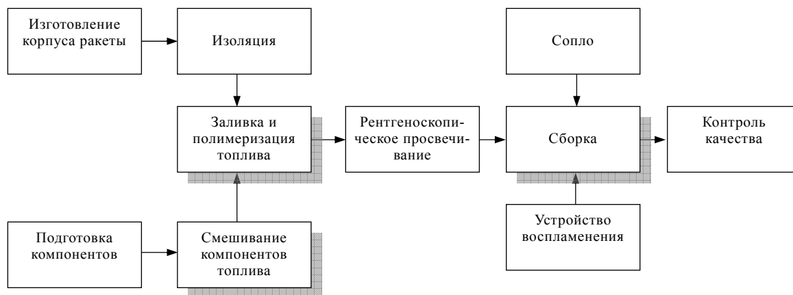
Рисунок I. Технологическая схема процесса производства двигательной установки, работающей на смесевом твердом топливе
