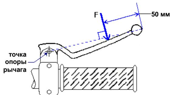
Усилие прилагается к точке, расположенной на расстоянии 50 мм от крайней точки рычага управления, измеренной вдоль оси между центральной осью точки опоры рычага и его крайней точкой.
