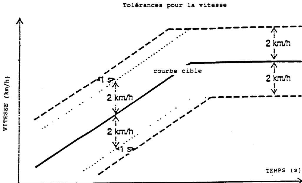
Les tolérances pour la vitesse ( $\pm 2$  km/h) et pour le temps ( $\pm 1$  s) sont géométriquement combinées à chaque point ainsi que le montre la figure 4.
