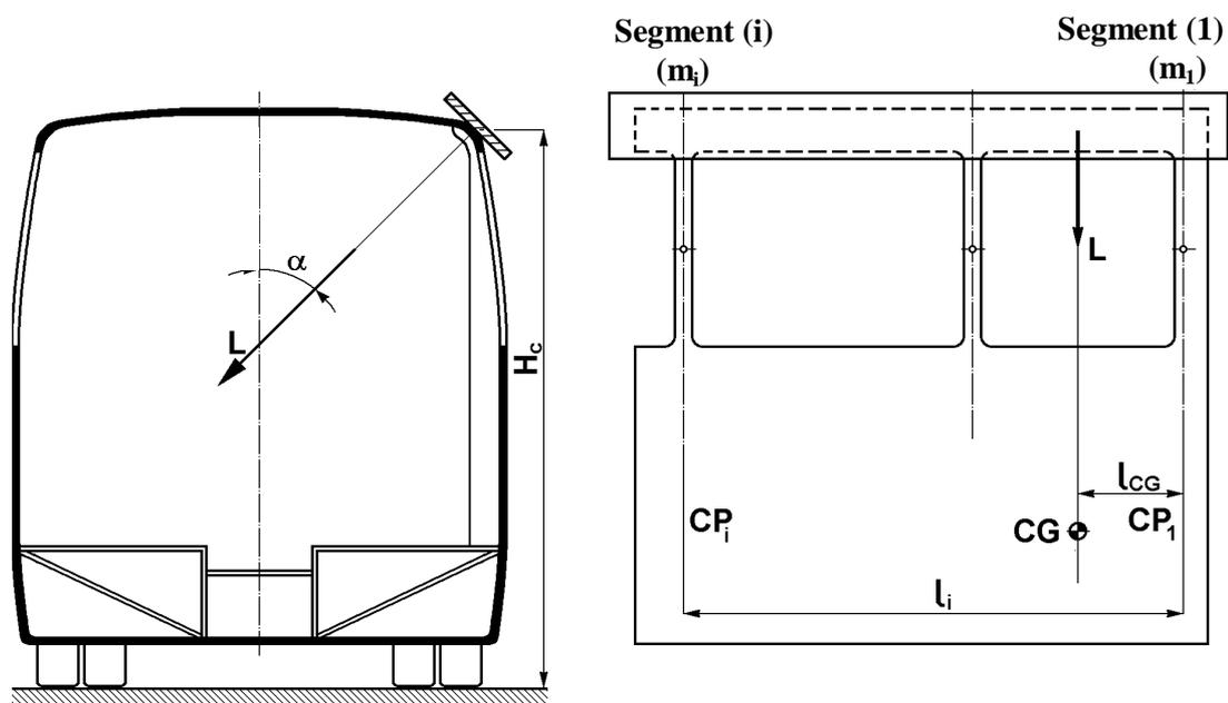
Figure A7.1 – Application de la force à la section de caisse
