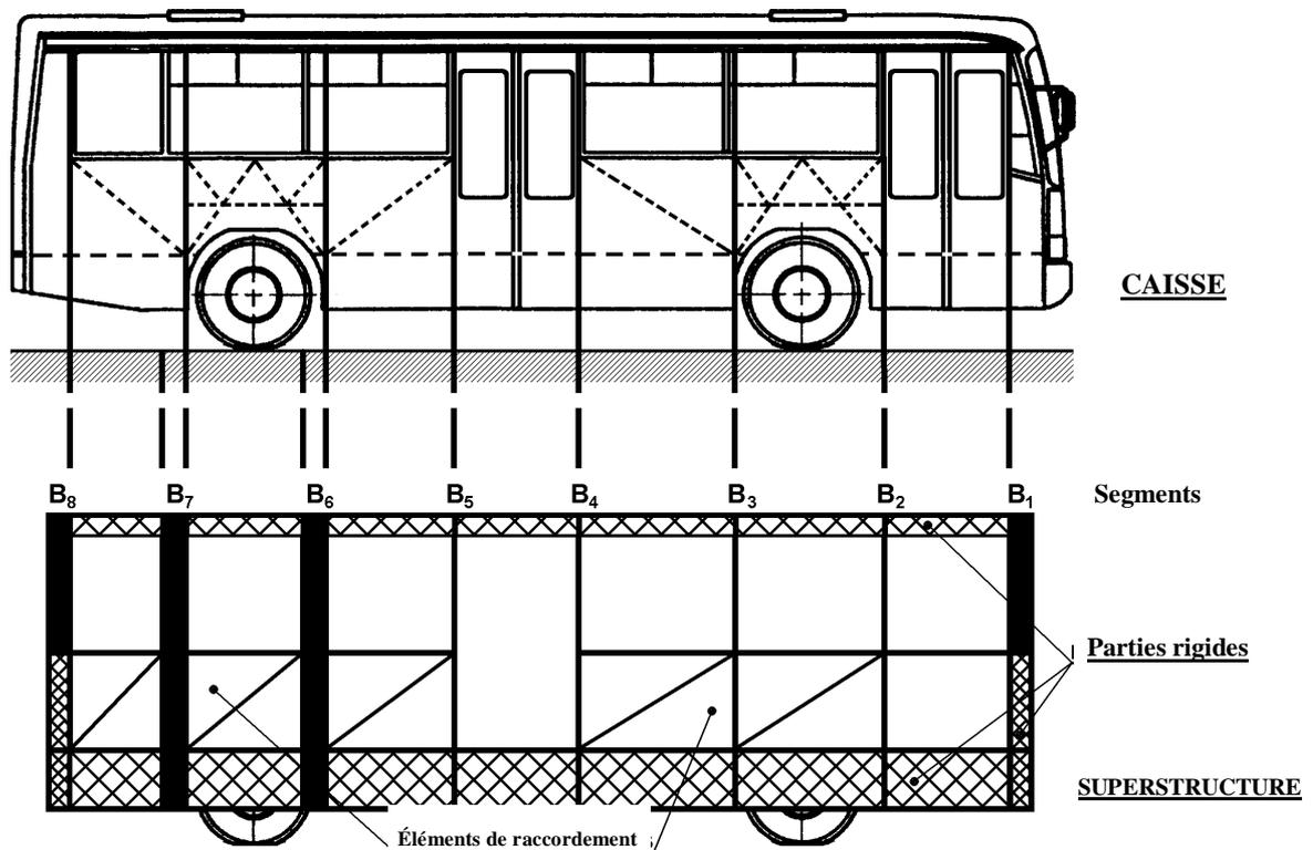
Figure A4.1 – Définition de la superstructure à partir de la caisse
