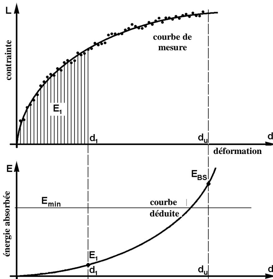
Figure A7.2 – Énergie absorbée par la section de caisse, déduite de la courbe de mesure contrainte/déformation
