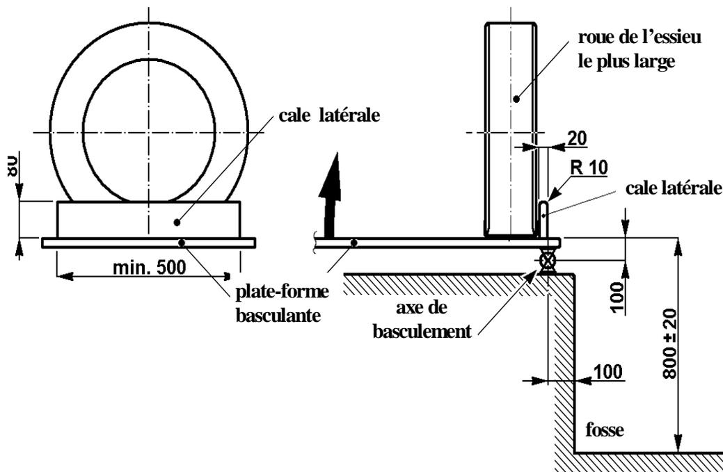
Figure A5.1 – Cotes géométriques du banc de basculement
