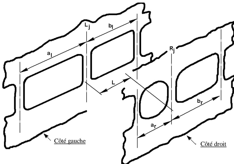
Figure A4.3 – Définition de la longueur d'un segment lorsque les montants de chaque côté du segment ne sont pas dans un même plan transversal.
