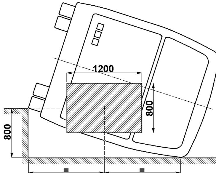
Figure A5.2a – Champ de vision recommandé pour les caméras de prise de vue extérieure
