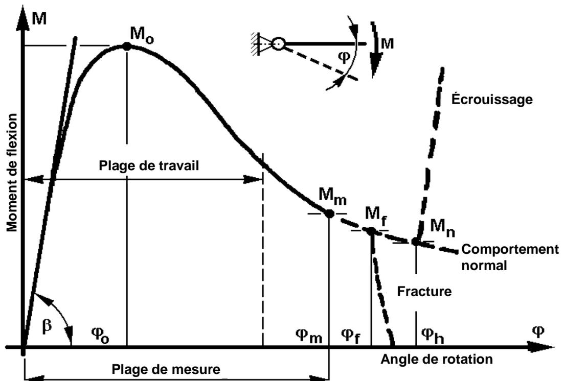
Figure A8.A1.1 – Courbe caractéristique d'une articulation plastique
