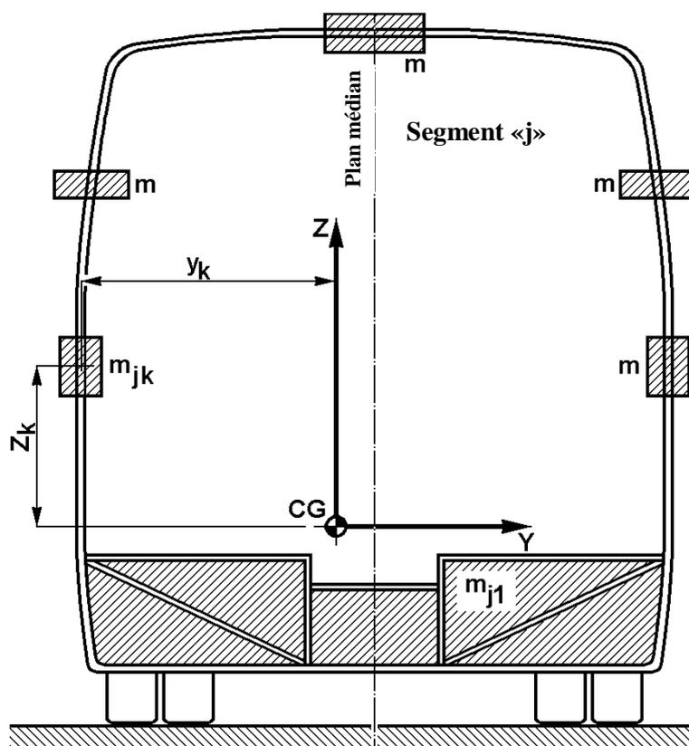
Figure A4.4 – Répartition des masses dans la section transversale d'un segment
