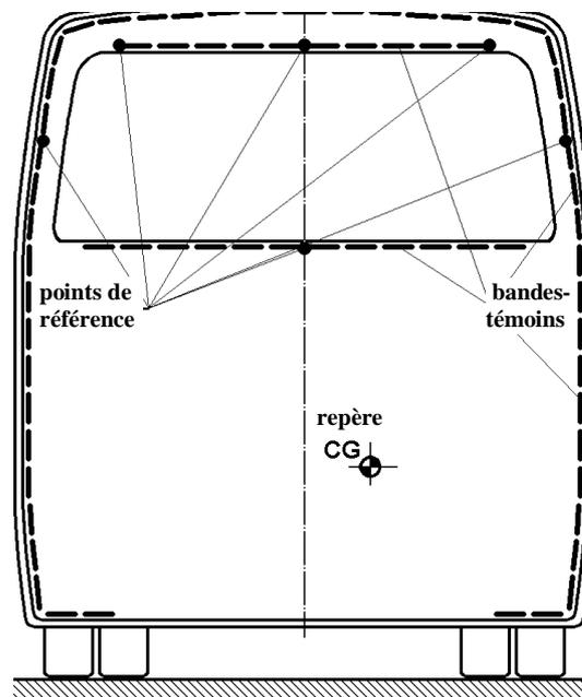
Figure A5.2b – Marquage recommandé pour la position du centre de gravité et le contour du véhicule
