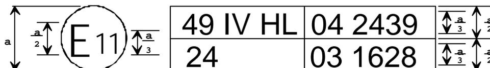
La marque d'homologation ci-dessus, apposée sur un moteur ou un véhicule, indique que ce type de moteur ou de véhicule a été homologué au Royaume Uni (E11) en application des Règlements No 49 (niveau d'émissions IV) et No 24 1/. Les deux premiers chiffres des numéros d'homologation signifient qu'aux dates où les homologations respectives ont été accordées, le Règlement No 49 comprenait la série 04 d'amendements et le Règlement No 24 comprenait la série 03 d'amendements.
