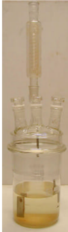
Figure 37.4.2: Réacteur avec réfrigérant à reflux
