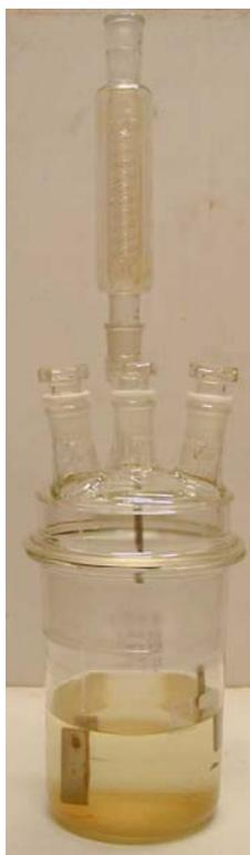
Para la prueba de corrosión, hay que disponer de una cantidad mínima de la sustancia corrosiva por clasificar de 1,5 l para que el agente no se agote antes del fin del tiempo de exposición. Una prueba que dure mucho sin cambiar la solución puede a veces producir resultados negativos. Para obtener resultados ajustados y evitar el tener que volver a empezar las pruebas, hay que tener en cuenta las siguientes observaciones :
