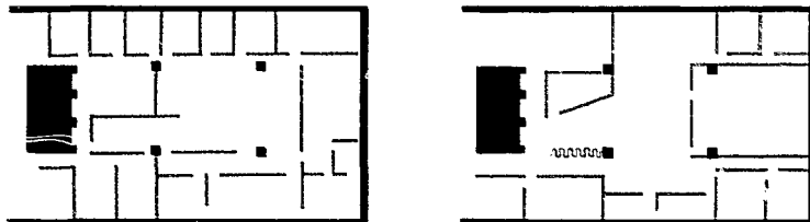
Disposition modifiable grâce à des parois mobiles
