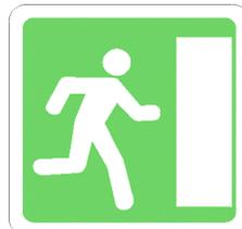
Il est également nécessaire de signaler les deux issues les plus proches sur les parois latérales, tous les 50 mètres environ, à une hauteur de 1–1,5 mètre. Des exemples sont présentés ci-dessous:
