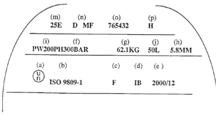
6.2.5.7.5 В других местах, помимо боковых стенок, разрешается наносить и другие маркировочные знаки при условии, что они размещаются на участках, не подверженных сильному напряжению, и по своему размеру и глубине не создают опасных концентраций напряжения. По своему содержанию эти маркировочные знаки не должны противоречить требуемым маркировочным знакам.
