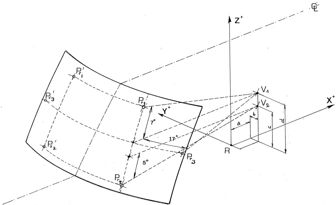
$C_L$ : trace du plan médian longitudinal du véhicule
