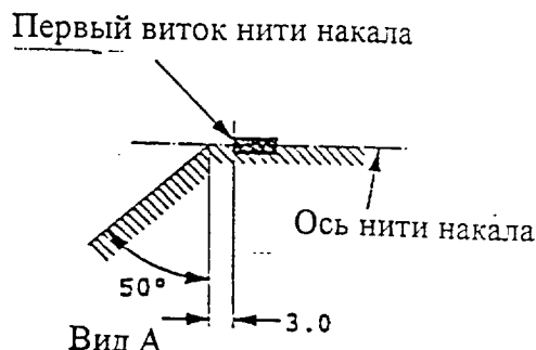
Рис. 4 - Зона без металлических частей 6/
