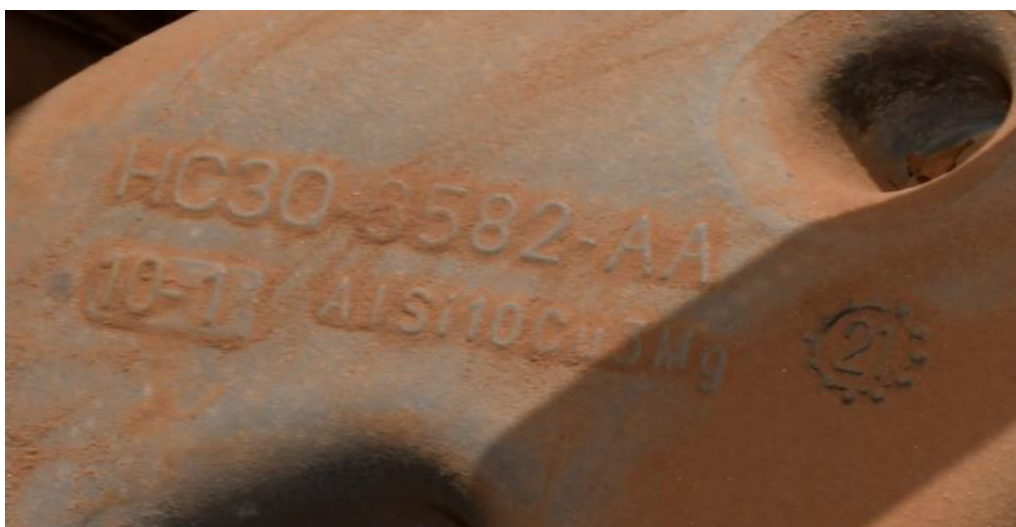
(f) Nimr II 型装甲车，机器序列号 HC30-8582-AA AlSi10Cu5Mg1。
