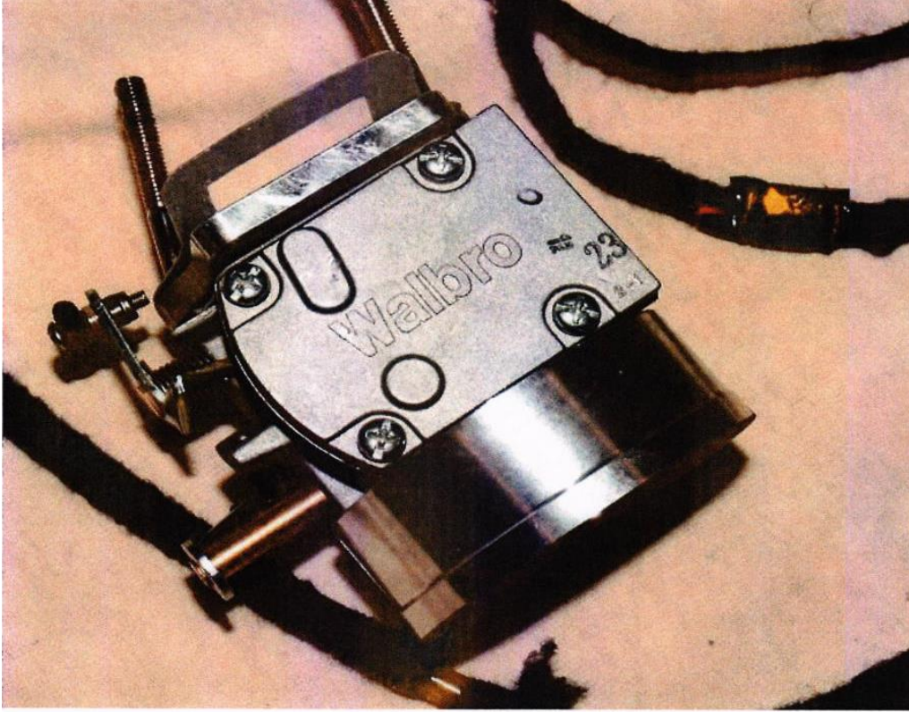
- 一架大型自杀式无人机的零件，上面刻有“Walbro 23”字样。
