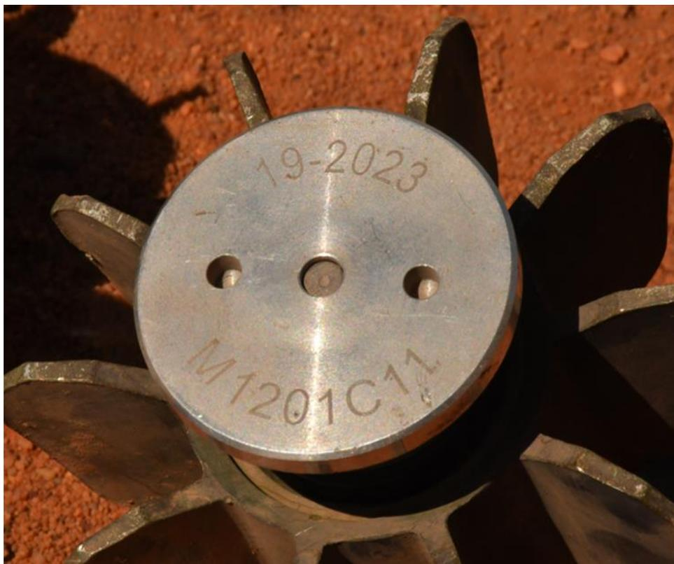
6. а) Осколки 120-мм мин сербского производства, изготовленных в мае 2023 года, серийный номер M1201C11.
