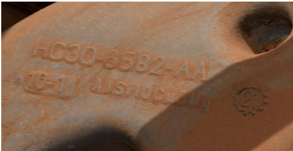
f) Бронеавтомобиль “Nimr II”, серийный номер HC30-8582-AA AISi10Cu5Mg1.
