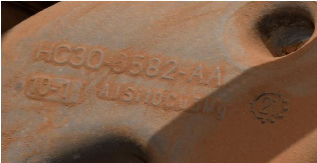
(و) رقم الماكينة المتسلسل لمدرعة النمر 2 (HC30-8582-AA) (AlSi10Cu5Mg)
