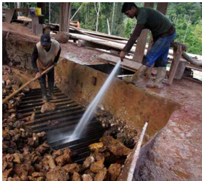
Kuonyesha jedwali jipya ambalo hutumia maji na mvuto pekee kama njia mbadala dhidi ya mbinu ya kawaida zaidi ya kutumia zebaki kufua dhahabu kutoka kwa madini. Picha: Ranu Abhelakh/Reuters
