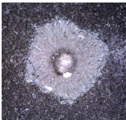
Folge eines Aufpralls auf die Triebwerksdüse des Reaktionskontrollsystems eines Flugkörpers der Crew-4. Vergrößerung: 59,3 x.
