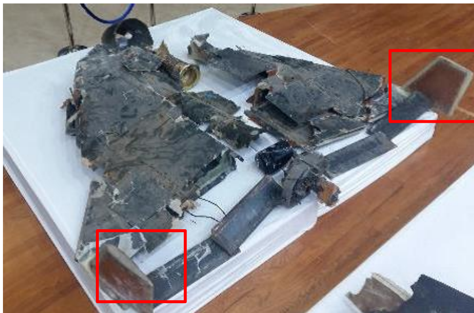
图 11：沙特阿拉伯王国(2019)展示的 Shahed-131 碎片，图中突出显示了机翼稳定器
