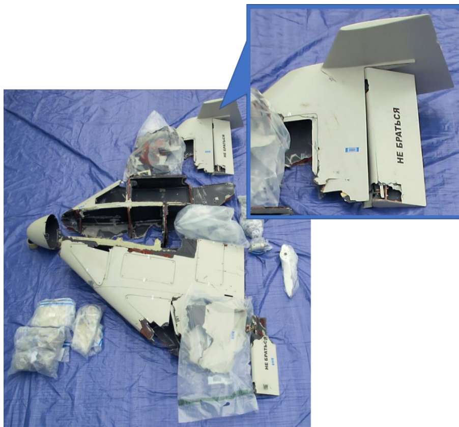
图 15：乌克兰借给联合王国的 Shahed-136 系统，图中突出显示机翼稳定器
