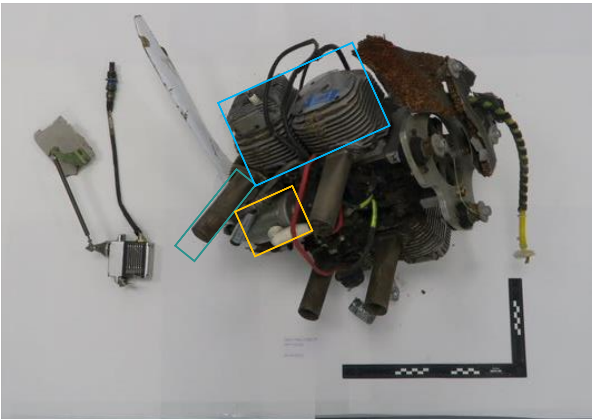
Figure 15 : Un drone Shahed-136 prêté par l'Ukraine au Royaume-Uni ; les composants moteurs sont indiqués en couleurs.
