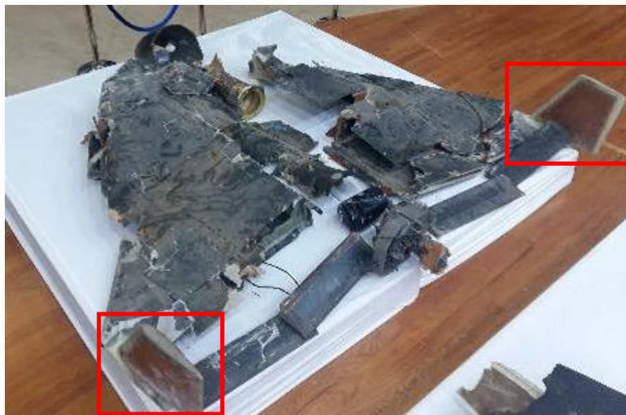
Figure 11 : Débris du Shahed-131 montrés en Arabie saoudite (2019) : les stabilisateurs d'ailes sont encadrés en rouge.
