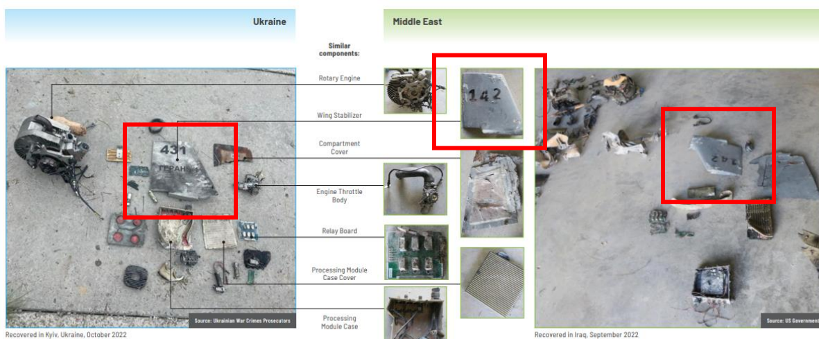
Figure 9 : Comparaison des composants du Shahed-131 établie par la Defence Intelligence Agency (États-Unis)..
