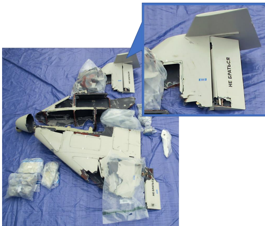
Figure 15 : Drone Shahed-136 prêté au Royaume-Uni par l'Ukraine : la photo du stabilisateur d'aile a été agrandie.
