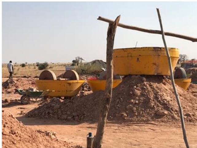
Figure XII Machines de broyage de l'or, Menawachei, février 2020
