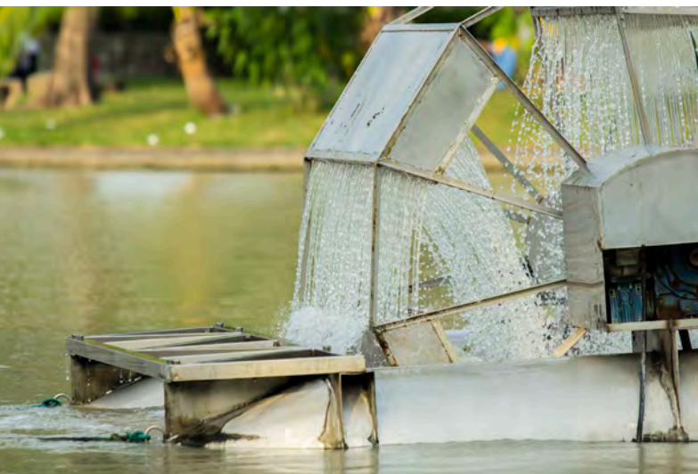
Водяная турбина Чайпаттана в общественном парке, Тайланд
