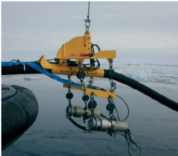
Fig. 5. Dispositif pneumatique d'acquisition de données ad hoc, mis au point par l'Université de Bergen et embarqué sur le brise-glace « Oden ».
