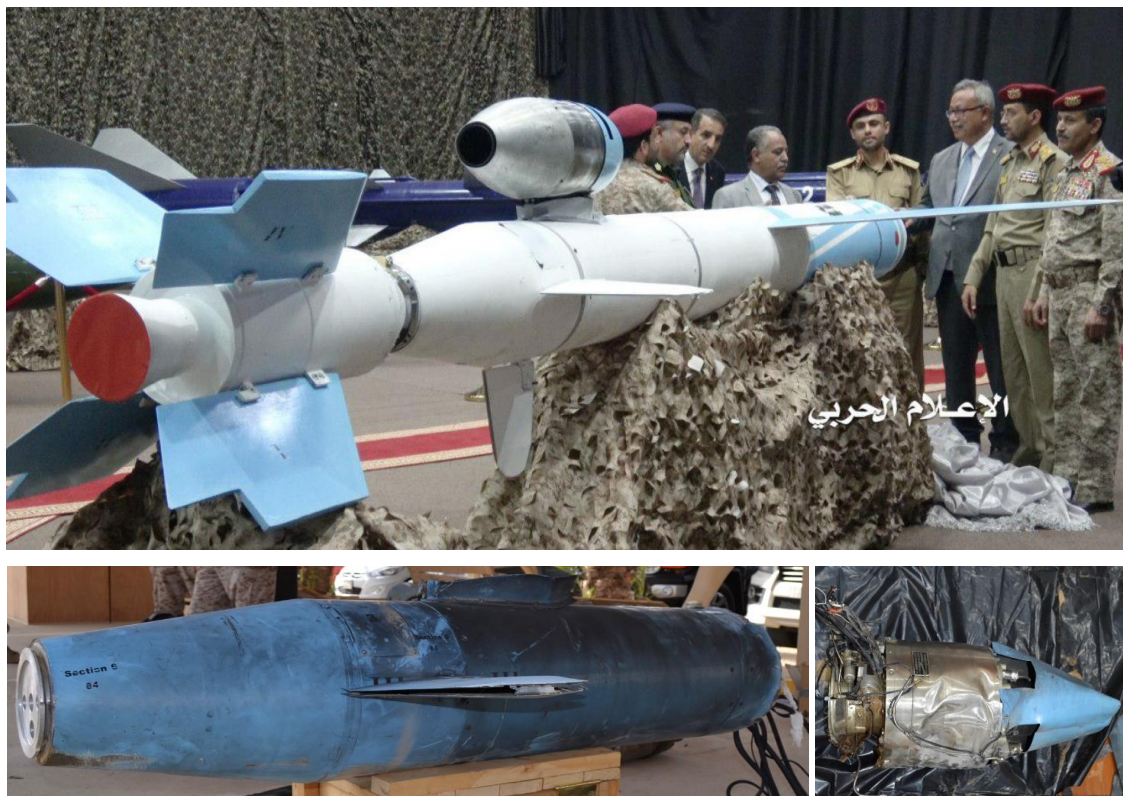
Figura V Exhibición del vehículo aéreo no tripulado Quds-1 (arriba) y restos de misiles inspeccionados en la Arabia Saudita (abajo)
