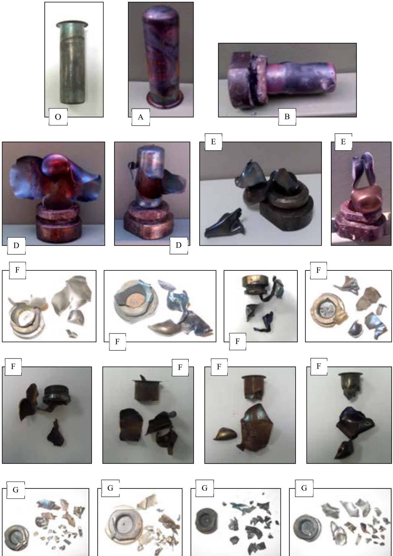
Figure 18.6.1.4 : Exemples de résultats de l'épreuve de Koenen
