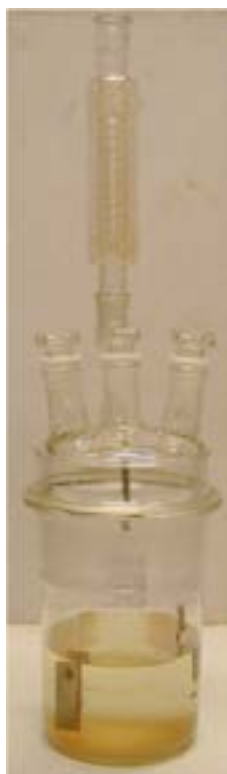
Figure 37.4.2.2 : Réacteur avec réfrigérant à reflux
