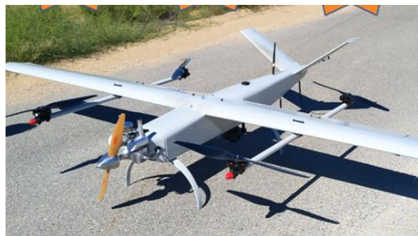
Figura XII Imagen de los fabricantes del dron Chilong CL-11 VTOL
