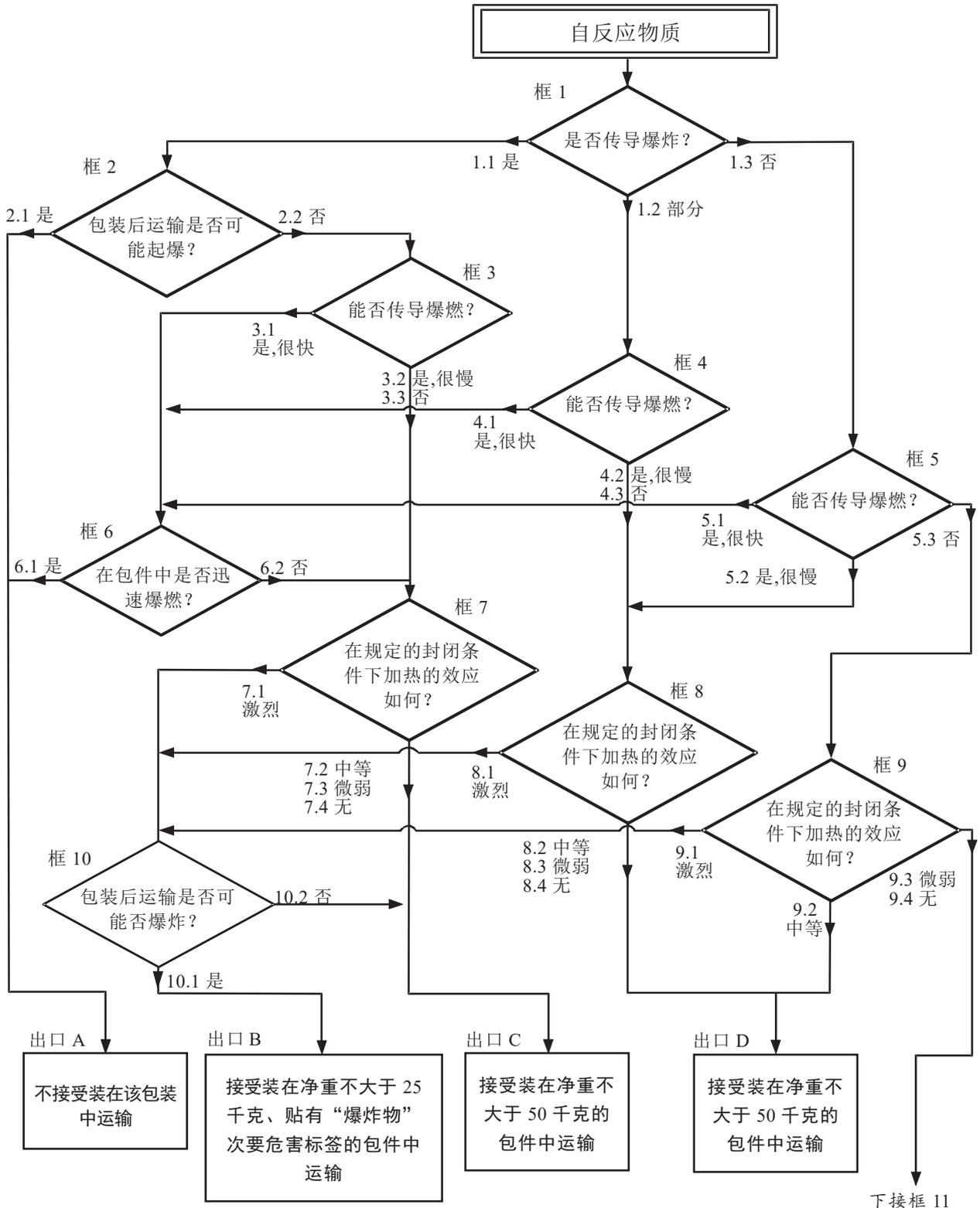
图 2.4.1 自反应物质的分类流程图(续)
