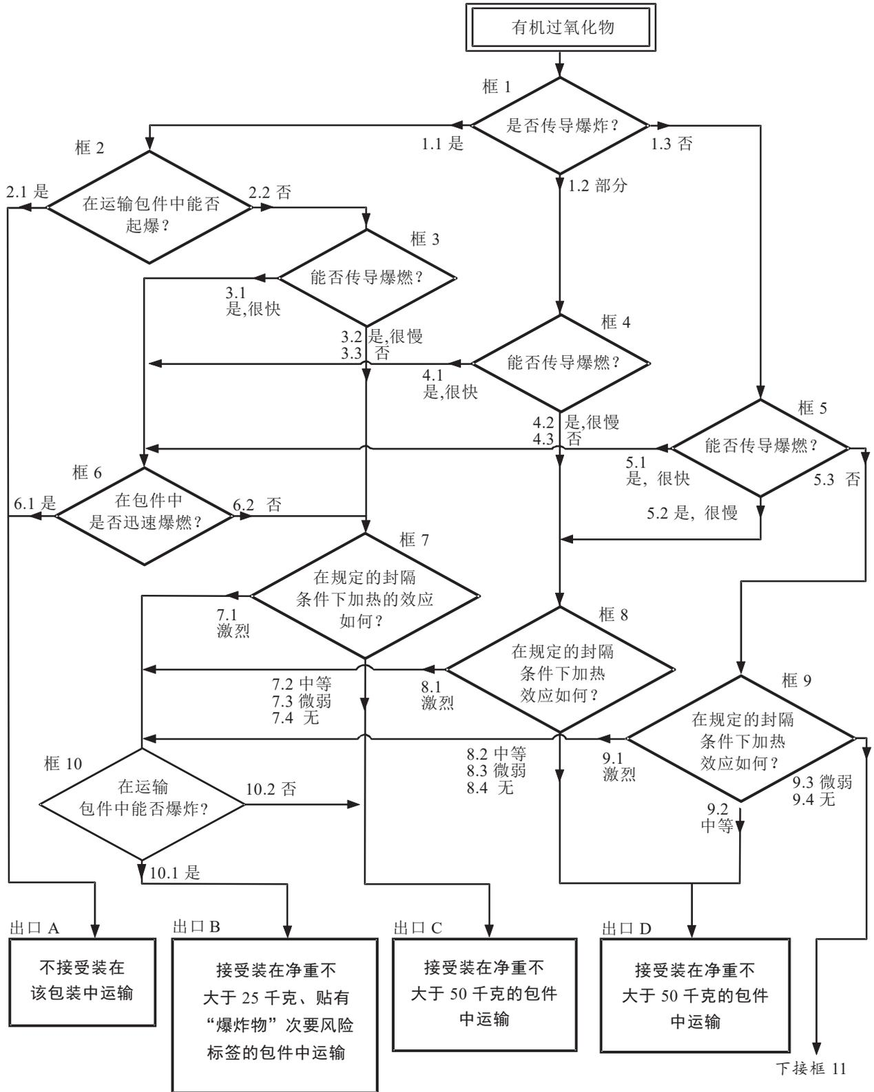
图 2.5.1: 有机过氧化物分类流程图(续)
