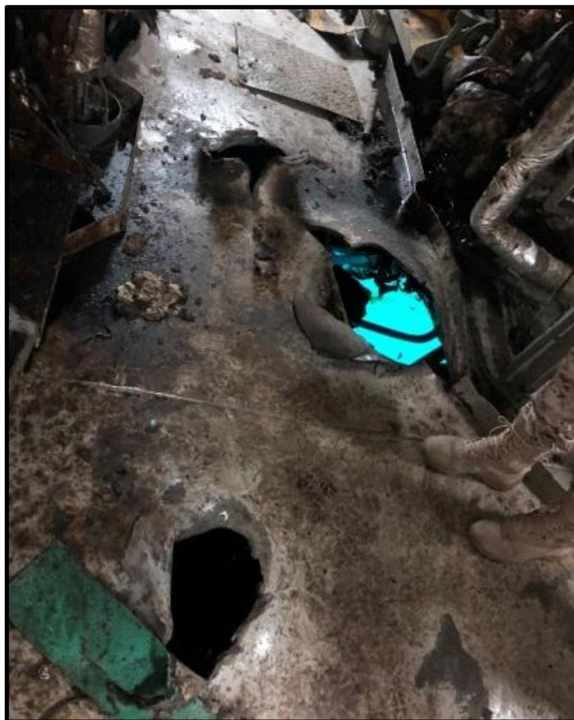
*Figure 3 : Dommages subis par l'Amjad sous le local des séparateurs, dans la salle des machines*
