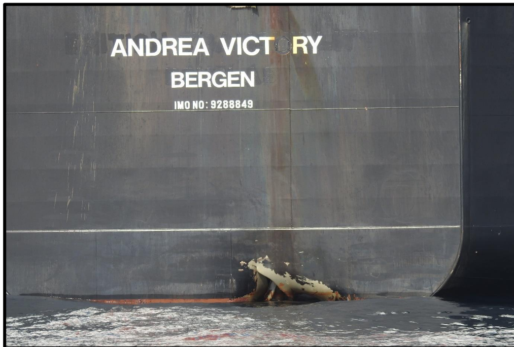
Imagen 20: Foto del exterior del Andrea Victory en la que se ven los daños en el casco.
