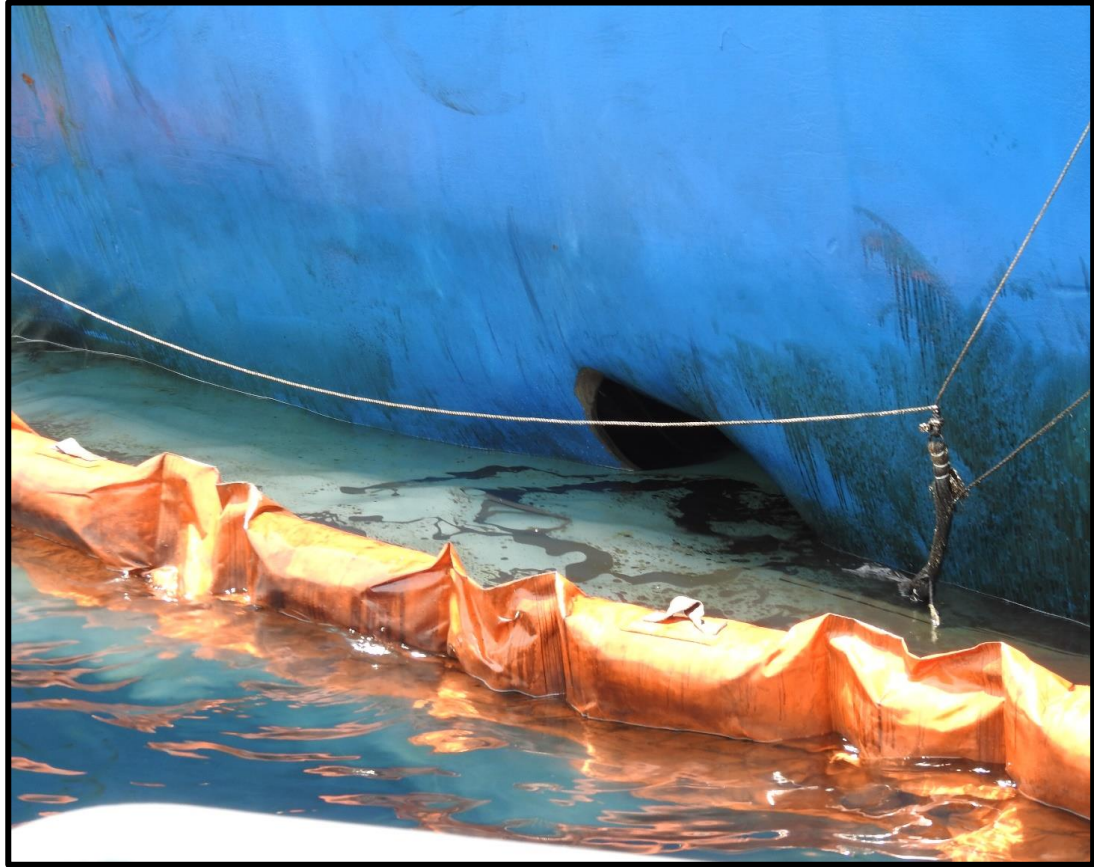
Imagen 15: Foto del exterior del A. Michel en la que se ven los daños en el casco.
