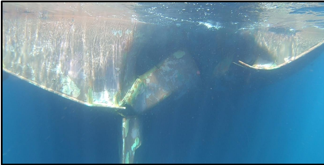
الشكل ٢١: الضرر الذي لحق بهيكل الناقلة "أندريا فيكتوري"
