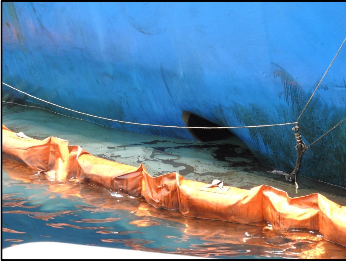
الشكل ١٥: الجانب الخارجي للناقلة "A.MICHEL" يظهر الضرر الذي لحق بهيكل الناقلة
