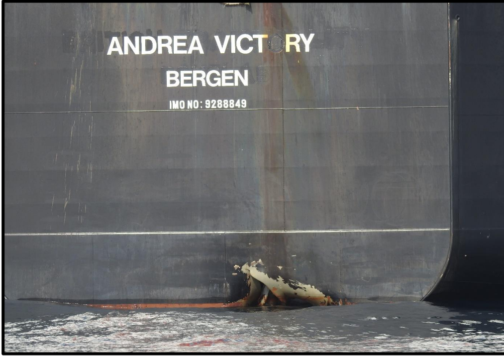
الشكل ٢٠: صورة للجانب الخارجي للناقلة "أندريا فيكتوري" توضح الضرر الذي لحق بهيكل الناقلة
