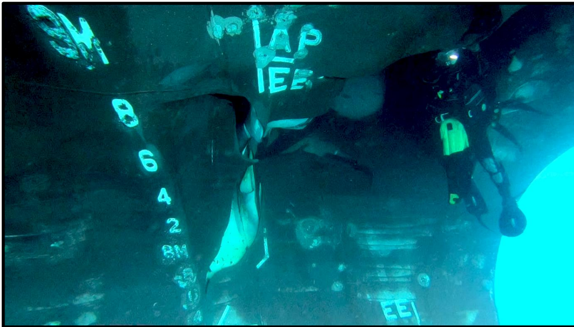
الشكل ١١: صورة تظهر أحد الغواصين أمام الهيكل المتضرر للناقلة "المرزوقة"
