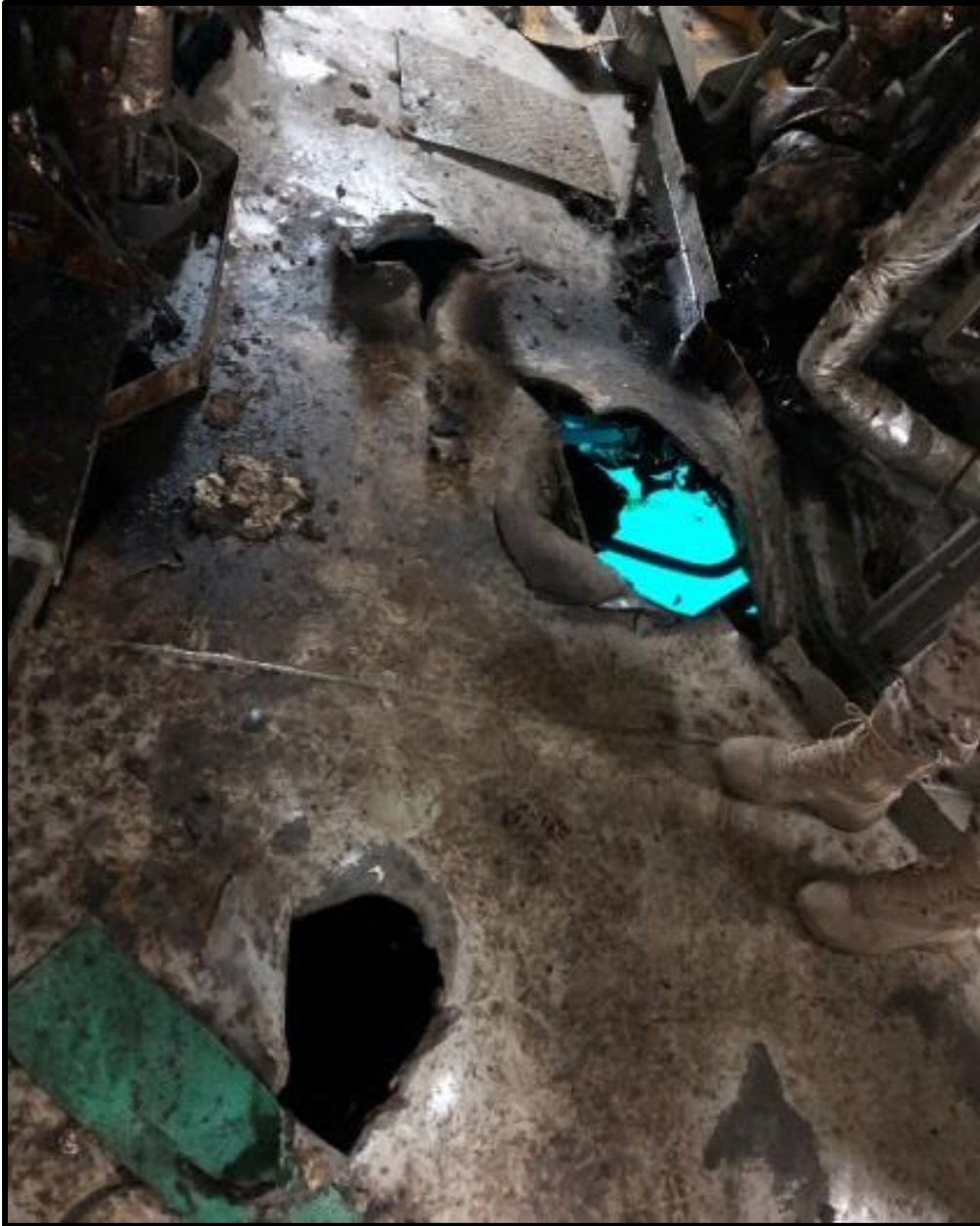
الشكل ٣: الضرر الذي لحق بالناقلة "أمجد" أسفل حجرة التنقية في غرفة المحركات
