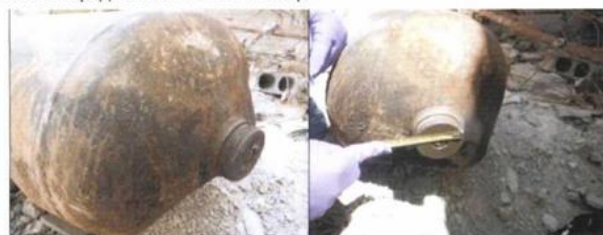
Состояние баллона не соответствует деформации, которую он мог бы получить. Головная часть баллона должна получить более значительную деформацию
