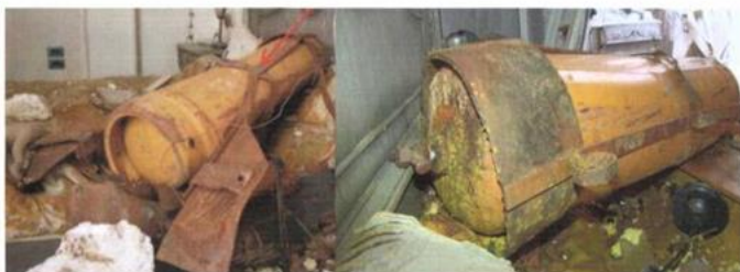
При плоском проникании корпус баллона должен иметь более уплощенную форму. Перья стабилизатора, штырь в головной части и другие навесные элементы должны иметь значительные деформации или отсутствовать
