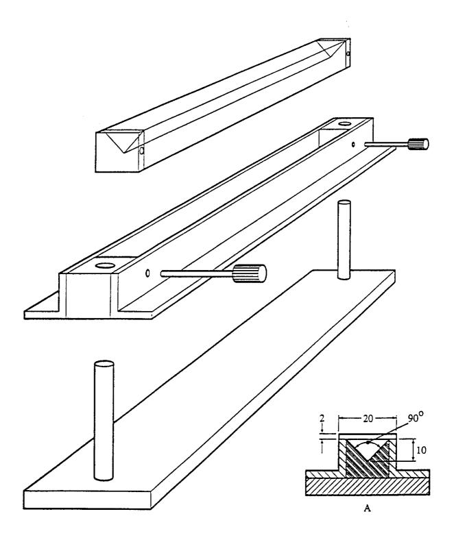
Longueur du moule : 250 mm Dimensions en millimètres
