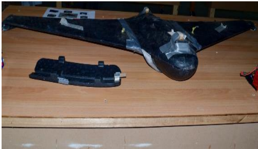
图四 基于民用天行者 8-X 制造的 Rased 型无人驾驶侦察机
