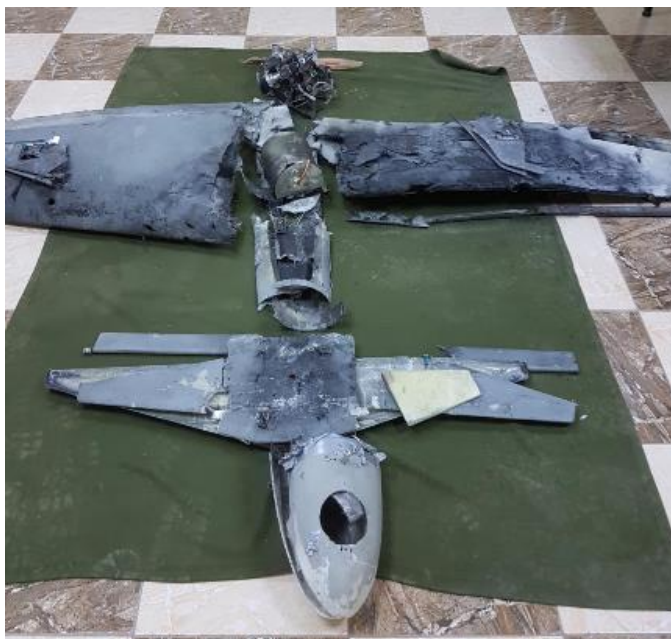
Figura V Munición merodeadora Qasef -1, basada en el misil Ababil-2/T
