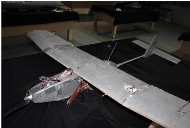
Figura VI Vehículo aéreo no tripulado de reconocimiento Hudhud-1, posiblemente desarrollado en el Yemen
