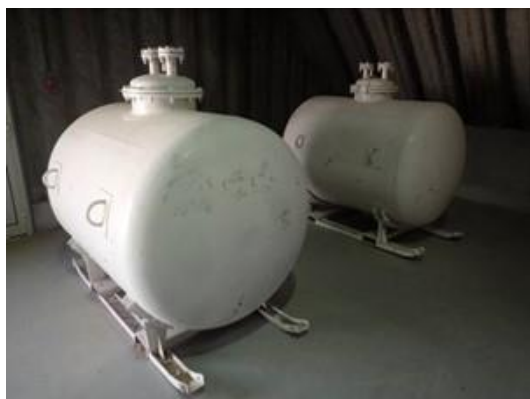
Figura IX Depósitos de campaña para almacenamiento de comburente confiscados cerca de Marib a
