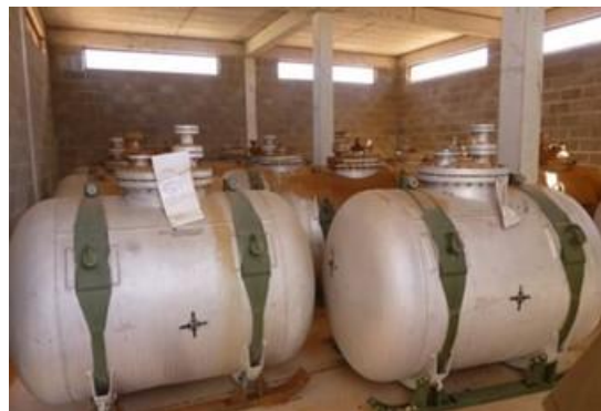
Figura X Depósitos de campaña para almacenamiento de comburente para misiles Scud a
