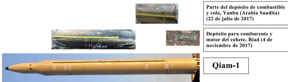
Figura IV Principales componentes y su posición relativa en comparación con un misil balístico de corto alcance Qiam-1 a
