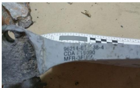
Изображение X Фрагмент крыльевого блока УАБ-12 с блоком наведения «Пейвуэй II» с кодом производителя (коммерческой или правительственной организации) 3FU05 135
