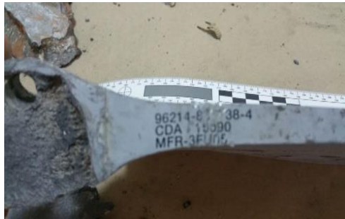
Figure X Fragment d'aile de dispositif de guidage GBU-12 Paveway II portant le code CAGE 3FU05 135
